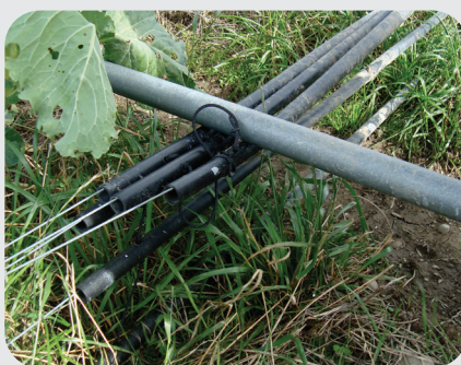
Conjunto das rodas do pivô na metade da linha da cerca com a barra defletora da cerca do irrigador segurando a linha da cerca.
