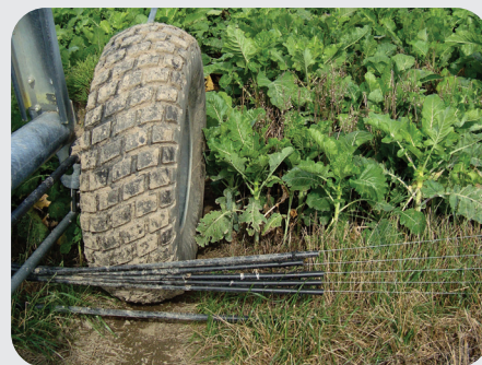
Conjunto das rodas do irrigador cruzando a linha da cerca.
