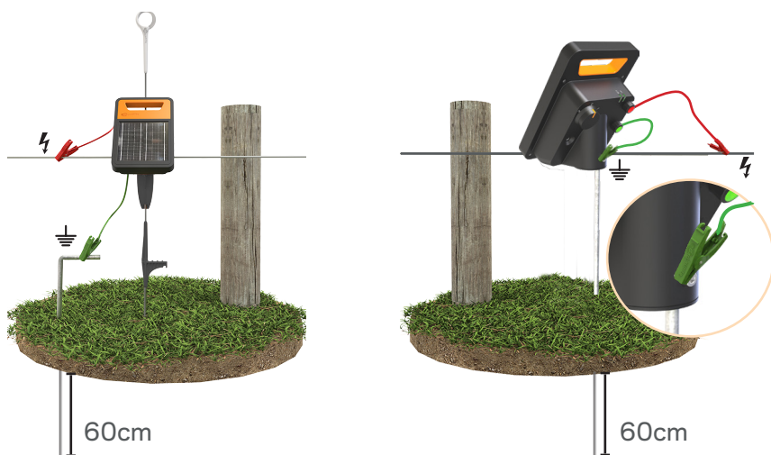
Aterramento para a Etapa 3 (a. b. c.)
